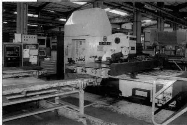
Cellule autonome de poinçonnage à commande numérique Behrens, point clé de production (Cl. JG)
