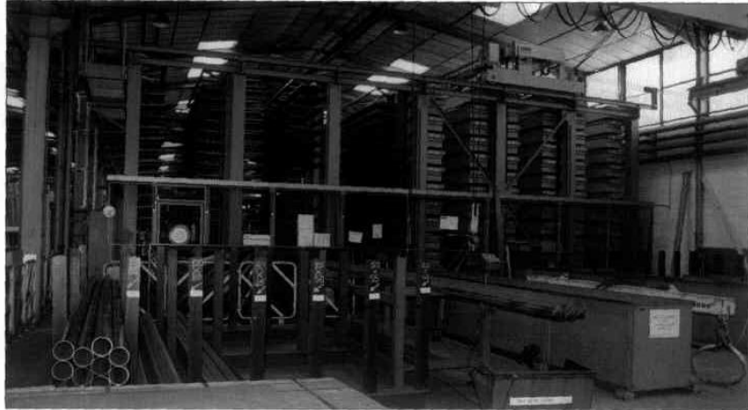
Magasin flexible de matières premières Kasto, expertisée pour une maintenance améliorée (Cl. JG)
