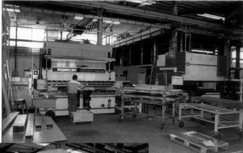
Presse-plier Promecam de l'atelier des portes. La GMAO historise les interventions sur chaque unité de production (Cl. JG)
