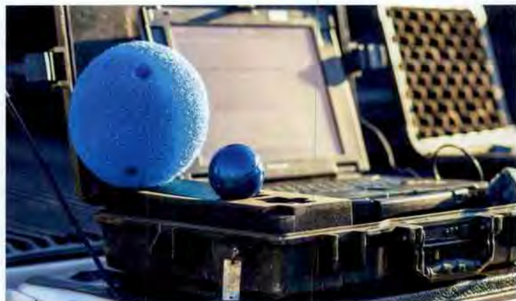
La Smart Ball de Pure Technologies, dotée de 24 heures d'autonomie, peut inspecter 20 à 30 km de conduite d'un seul tenant.
