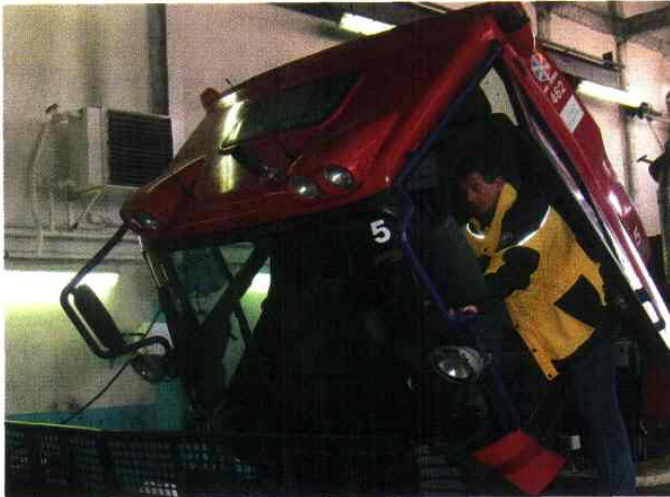
Opération de maintenance sur une dameuse, dans l'un des garages de la S3V
