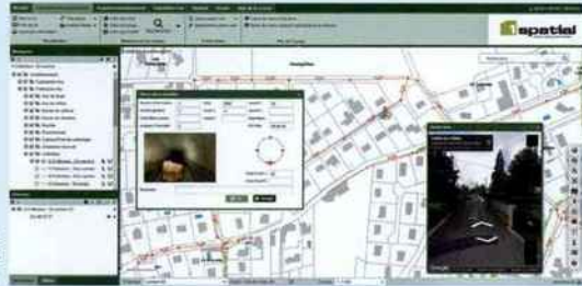
Gestion des interventions : zoom sur une anomalie résultat d'une inspection, visualisation de l'ITV.
